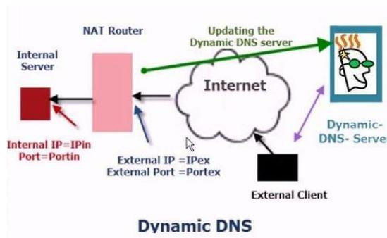
Ilustración 243. Diagrama de funcionamiento de un dominio dinámico [23].
